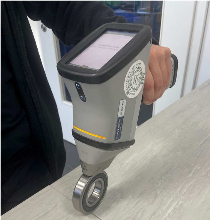
X-MET8000 XRF手持式设备用于无损分析滚动轴承
